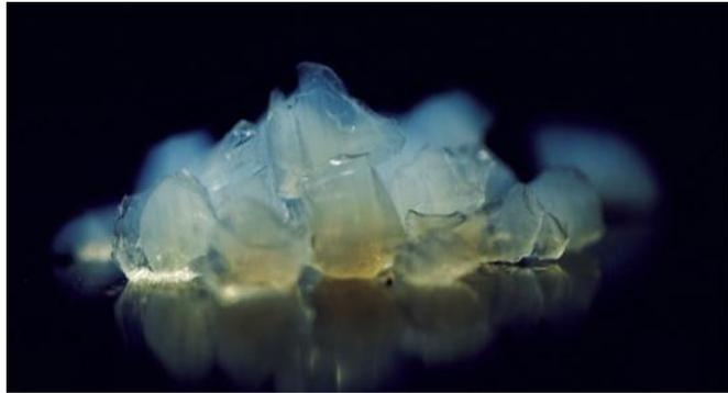
*Isogel@ de silice, super isolants développés conjointement par les chercheurs de PERSEE Mines ParisTech, PCAS et ENERSENS.*
